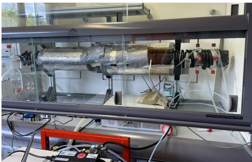
Abbildung 9 Aufbau der NO x -Prüfgasstrecke in Zusammenarbeit mit dem Messgerätepool des IFA. Es wurde eine konstante Luftfeuchtigkeit von etwa 53 % angestrebt, jedoch sorgten starke Schwankungen der Außentemperaturen für tatsächliche Luftfeuchten zwischen 48,5 und 64,2 %. Die Temperatur der Prüfgases lag für alle Messungen zwischen 21,3 und 23,8 °C.
